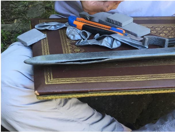
Laisser sécher la colle sur les deux surfaces en veillant à ce qu'elles ne soient pas en contact
