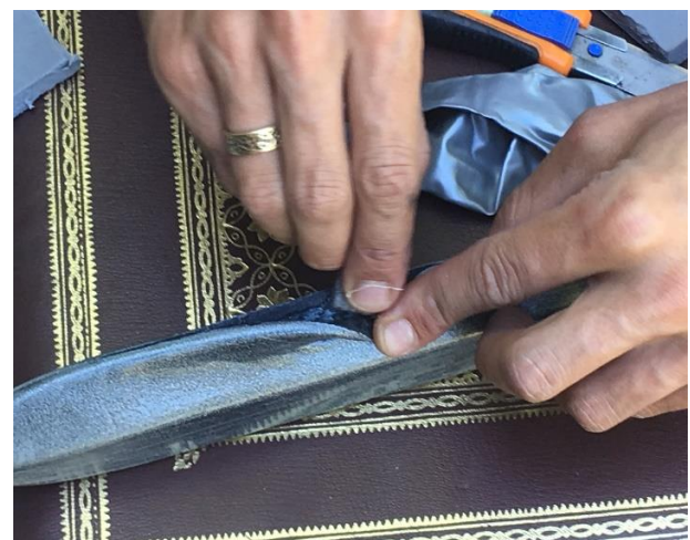
Étaler une FINE couche de colle sur les deux surfaces à joindre
