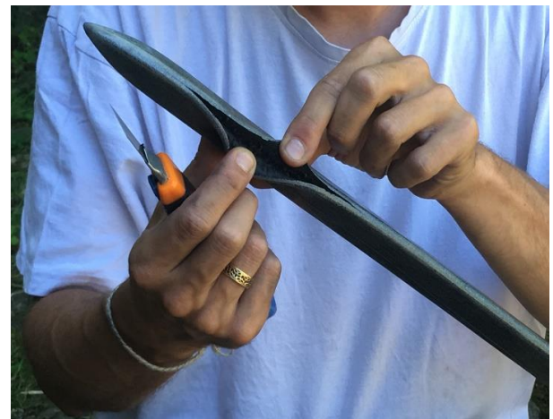
Ne pas hésiter à couper un peu plus large que le décolllement lui-même
