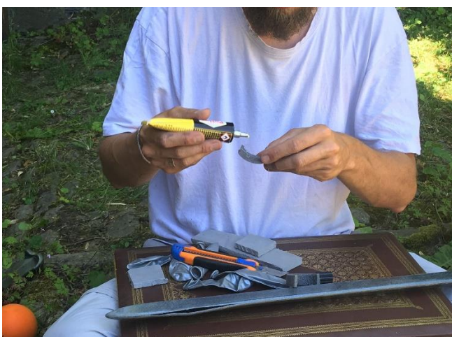
Utiliser un bout de mousse comme pinceau pour étaler la colle de contact
